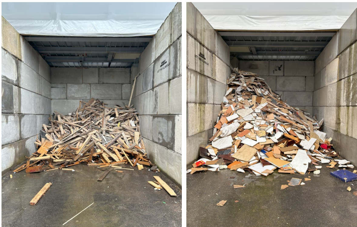
Kuvat 2 ja 3. Kuljetusrinki Oy:n lajittelulaitos, robotin erottelemia puujätejakeita. Vasemmalla käsittelemätön (luokka B eli kierrätyspuu) ja oikealla muu sekalainen eli käsitellyn puun jäte (luokka C eli purkupuu)
