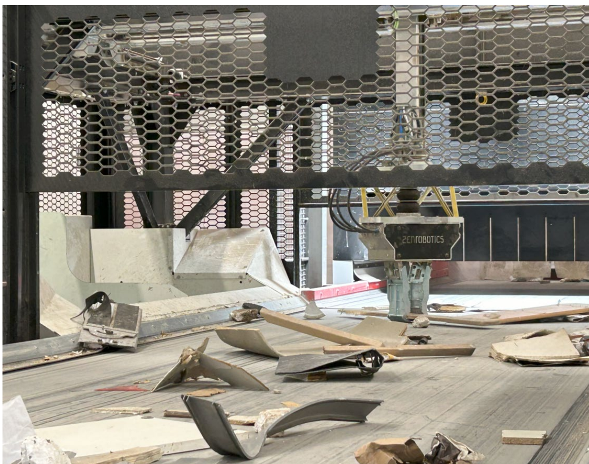
Kuva 1. Kuljetusrinki Oy:n lajittelulaitos, robotti erottelee puujätteen sekalaisesta rakennusjätteestä
